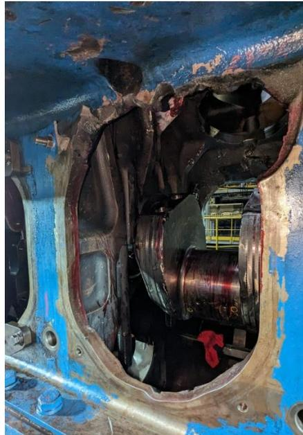
*Figura 6 Daño de cilindro A4 de unidad ECH-U5 (fuente propia)*
